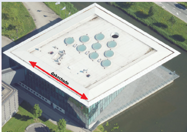
Dakplattegrond locatie dakschade
