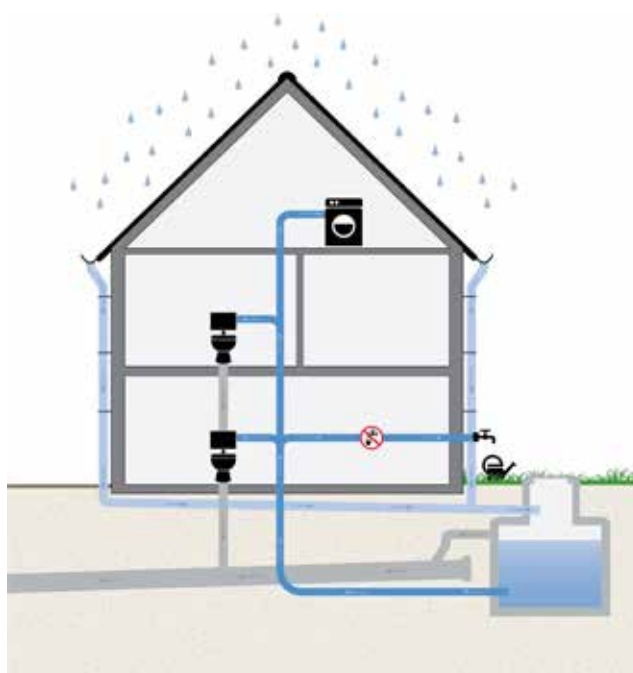
Schematische doorsnede regenwater-gebruikssysteem © Atelier GROENBLAUW
