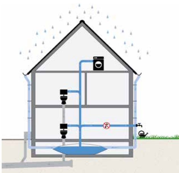
Schematische doorsnede regenwatergebruik-systeem met waterzak © Atelier GROENBLAUW
