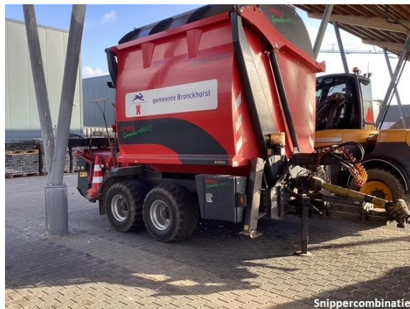
Snippercombinatie met K80 koppeling en K50 koppeling voor asbesturing.
