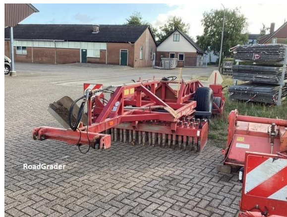
Road Grader t.b.v. onderhoud zandwegen, waarmee meerdere bewerkingen in een gang worden uitgevoerd.
