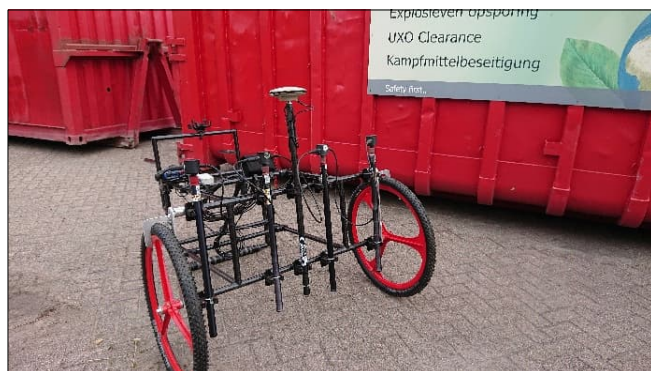
Figuur 3. Passieve non realtime oppervlakedetectie met het Vallon Multisondesysteem VXV4 en een staafdiagram waarop het maximale detectiebereik ( m^1 – maaiveld) per kaliber.
