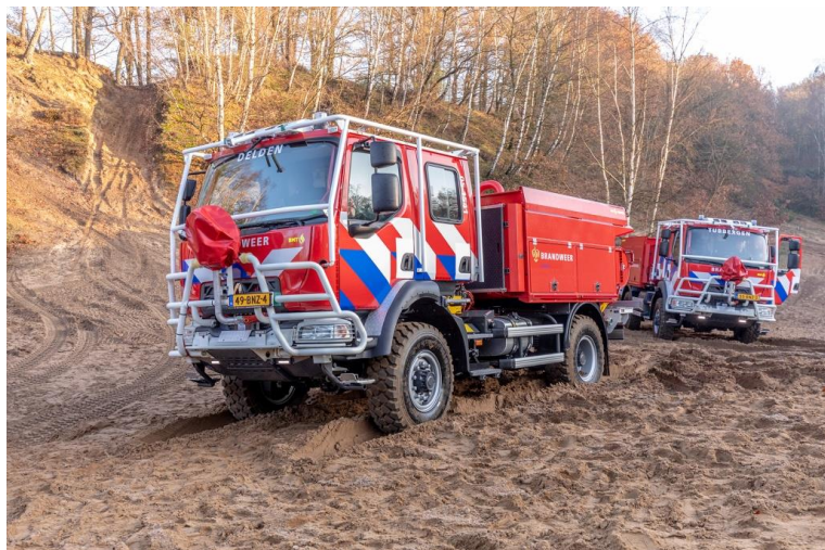
Afb.: TS-BT met veel bodemvrijheid onder opbouw en assen. Bron: BMT-Oss
