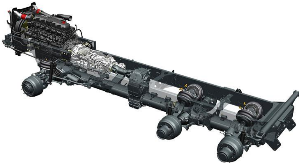
Afb.: Tatra 6x6 bedrijfswagenchassis, de langsliggers t.b.v. opbouwmontage boven op de buisvormige aandrijflijn, de luchtbalgen t.b.v. vering zijn binnen de langsliggerstructuur aangebracht i.p.v. onder of aan de buitenzijde naast langsliggers. De langsliggerstructuur dient hierbij hoofdzakelijk voor het dragen van de opbouw, de torsiekrachten worden verwerkt door de onafhankelijke wielophanging. Voor dit type chassis is het niet ondenkbaar dat een subframe achterwege kan blijven.
