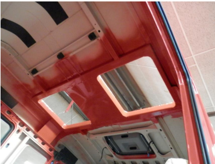
Afb.: Verstevigingsconstructie t.b.v. dakluiken. Bron: IFV
