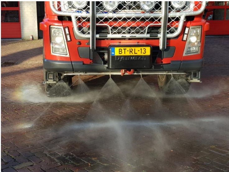
Afb.: Nozzles met verschillende capaciteiten en een vlak sproeibeeld. Bron : IFV
