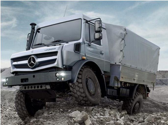
Afb.: UNIMOG, veerwegverlenging door ruime torsievrijheid in chassis. Bron: Mercedes Benz AG
