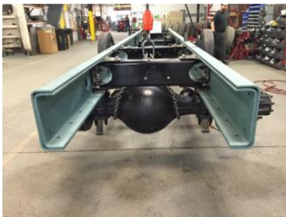
Afb.: Binnenversterking (inliners) in langsliggers Bron: Sutphen Fire Trucks
