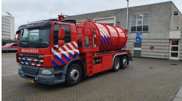
Afb.: TW-G voorzien van ronde tank met uitwendige versteviging Bron: VR IJsselland, post Deventer
