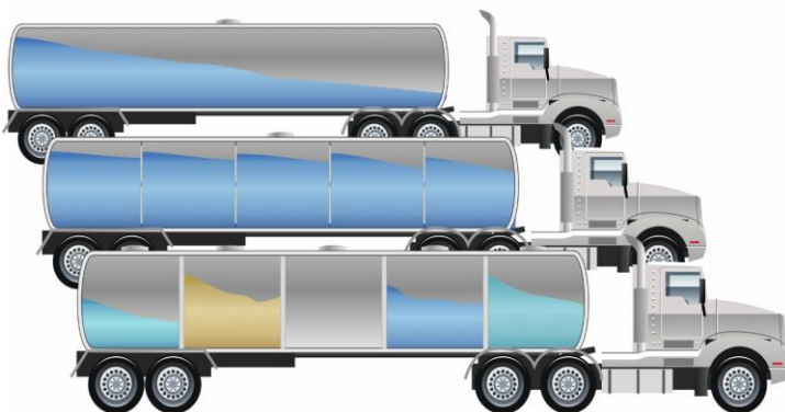
Afb.: Beperking van de vloeistofbewegingen, door slingerschotten (midden) of compartimentering (onder) Bron: onbekend
