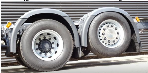
Afb.: Voor- of naloopas liften, Bron: Volvo Trucks
