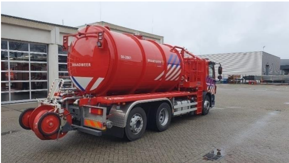
Afb.: TW-G voorzien van ronde tank met uitwendige versteviging Bron: VR IJsselland, post Deventer
