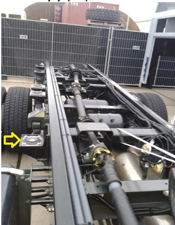
Afb.: Aandrijflijn naar pomp. Bron: NIPV
