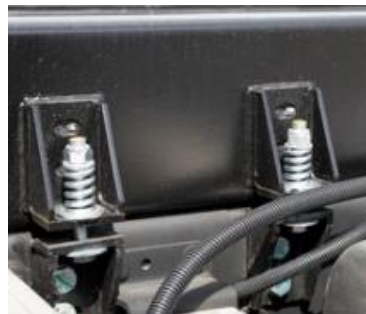
Afb.: Veerbelaste consolebevestiging (schuifvrij)
