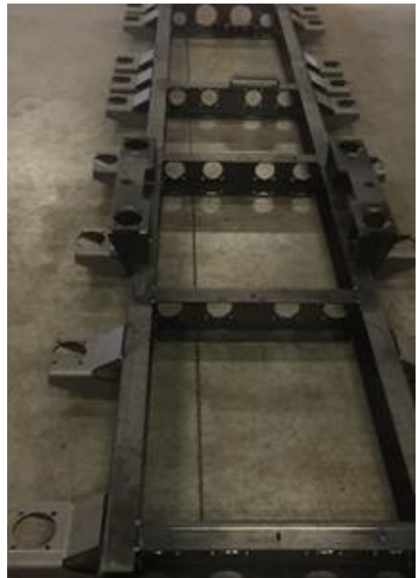
Afb.: Zichtbaar: langs- en dwarsliggers. Aan de buitenzijde van het frame links en rechts de consoles om de opbouw (tank) aan het subframe te bevestigen. Bron: IFFS
