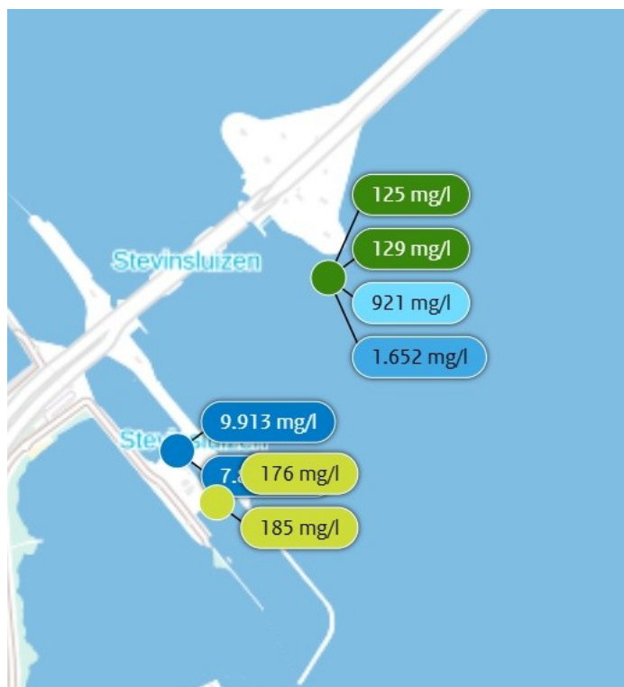
Figuur 8: chloridemeetpunten die onderdeel zijn van het vaste meetnet bij Den Oever
