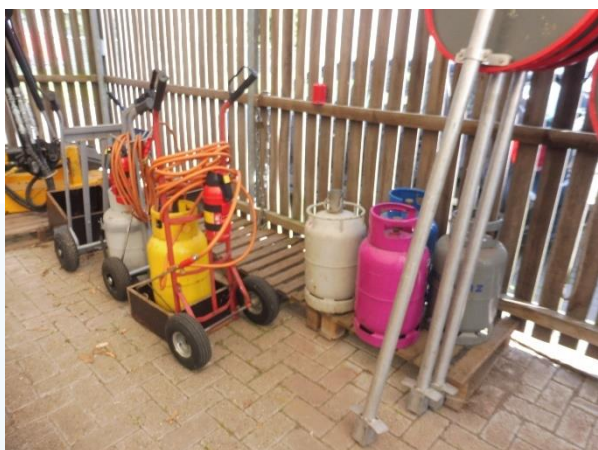
Geventileerde opstelling van gasflessen.
