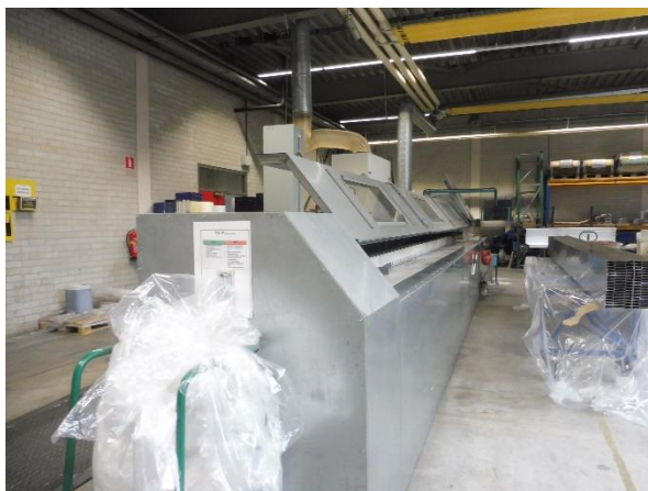
Machinaal zagen van aluminium profielen.
