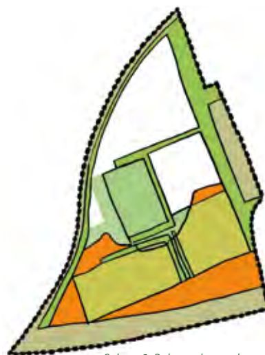
Schets 3: Bebouwbaar plangebied op basis van opgave gemeente, natuurwaarden, geluidsgrenzen en sportvelden
