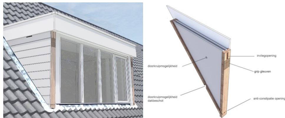
Figuur 24 Dakkapel met vleermuisvoorziening
