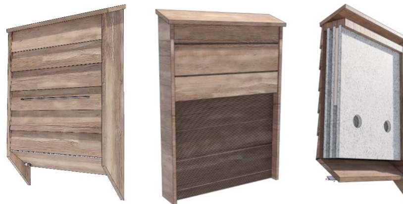
Figuur 15 Er zijn veel verschillende type grote type externe gevelkasten. Het principe is altijd hetzelfde, namelijk opbouw van meerdere lagen. Bij de laatste afbeelding is te zien dat in de voorlaatste laag extra isolatie is aangebracht. De hier afgebeelde kasten zijn gemaakt van hydrothermisch verduurzaamd hout, maar er zijn ook varianten van bijvoorbeeld multiplex verkrijgbaar.
