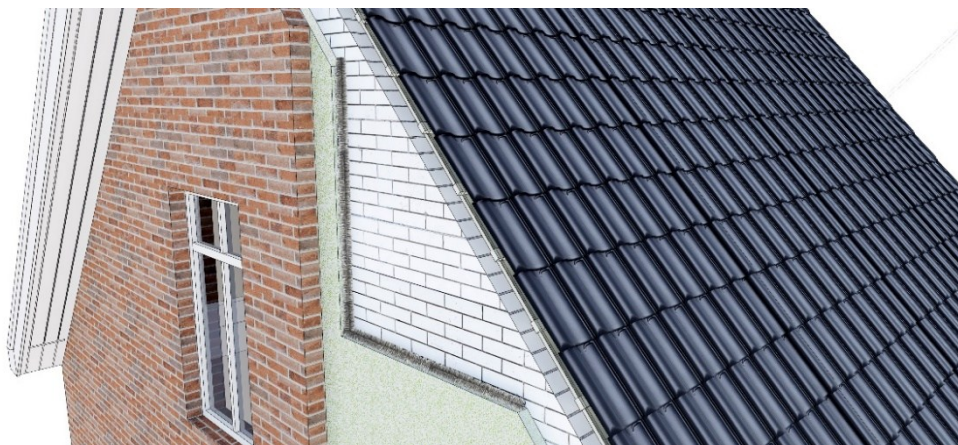
Figuur 9 Een deel van de spouw vrijlaten bij na-isolatie kan betrekkelijk makkelijk met spouwborstels. Wanneer mogelijk de bovenzijde in verbinding houden met het dakvlak.
