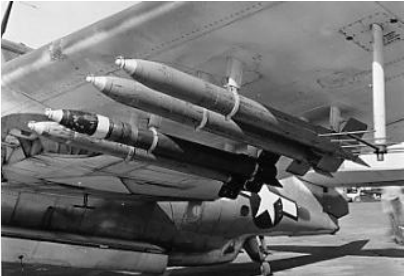
Figuur 24: Vier HVAR onder de vleugel van een Amerikaanse P-51 Mustang.
