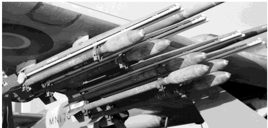
Figuur 20: Extra 60 lb. SAP-raketten gemonteerd op Hawker Typhoon
