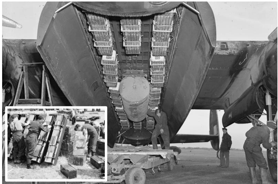
Figuur 48: Bommenlast bestaande uit een 4000 lb. HC brisantbom en meerdere SBC's met 236 stuks 4 lb. staafbrandbommen. 34
