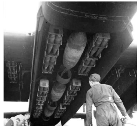
Figuur 47: Voorbeeld bommenlast van 1000 lb. brisantbommen in combinatie met 30 lb. brandbommen in bundels van acht
