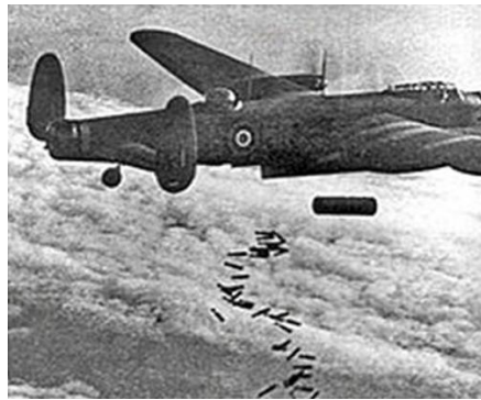
Figuur 46: Afwerpen en spreiding brandbommen door een Lancaster bommenwerper (links 30 lb. brandbommen en rechts 4 lb. brandbommen). 33
