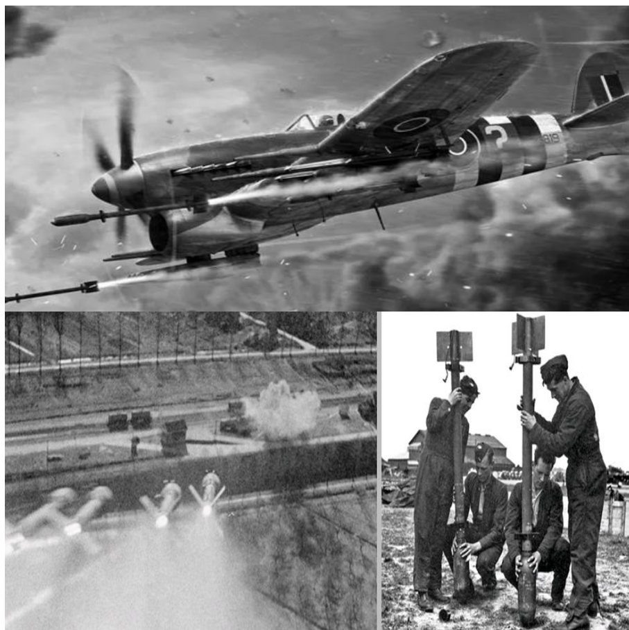
Figuur 17: Het afvuren van 3 inch luchtgronddoelraketten,, met onderin 3 inch raketten met een 60 lb. SAP gevechtsslading.
