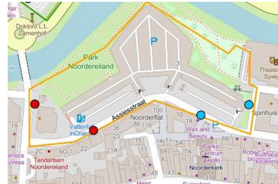
Figuur: inpassing WKO doubletten op basis van de voorkeursvariant (scenario 8) uit het bodem energieplan
