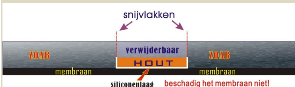
Figuur B7.14 Schema van het zagen van het PM proefstuk
