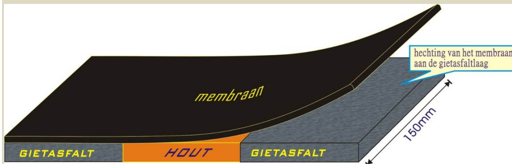
B7.10 Membraan-installatie op de bovenkant van GA
