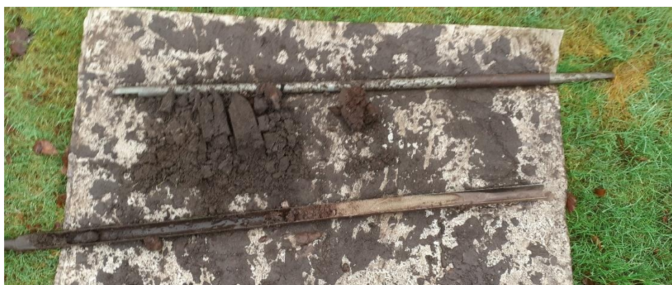
Afb. 19. Foto van boring 37, met tot een diepte van 50 cm -mv opgebrachte grond, tot 60 cm -mv veen en daaronder zwak grindig zand.
