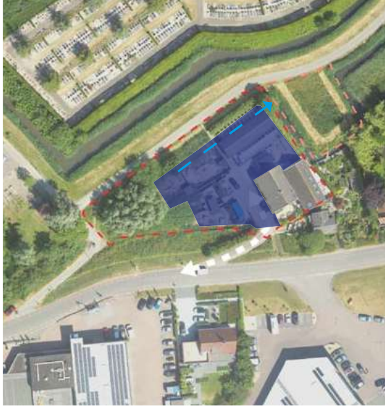
Afbeelding 2: Bestaand verhard oppervlak (blauw) hemelwaterafvoer (lichtblauw)
