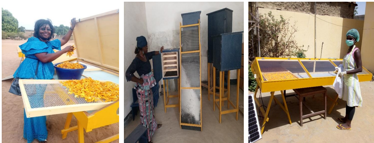
Photos : Séchoirs solaires en tunnel des entreprises PROMOSOL et REMA BIO à N'Djamena
