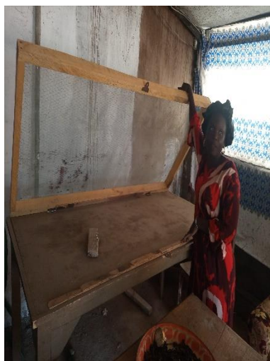
Photos : Tables de Séchage au soleil en bois de l'Association MAVIE à Moundou, ou de Four Solaire de NAVIRE – MARCHANDE, à N'Djamena
