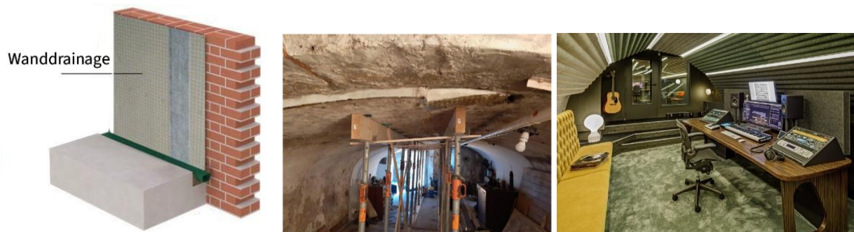
Figuur 4 - principe stucplaat op folie, een voorbeeld van een ernstige schade die verborgen was door de stucplaat en aftimmering
