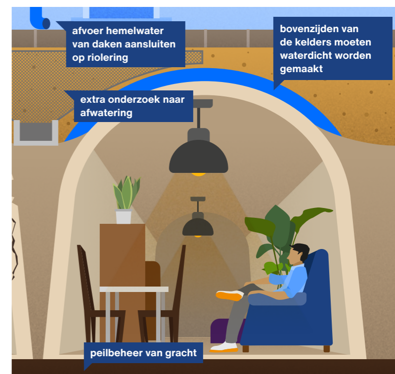
Figuur 5. Boven: aanpak voor uitsluitend behoud van het erfgoed en veiligheid. Onder: aanpak behoud van erfgoed, veiligheid en bovendien geschikt maken voor hedendaagse functies
