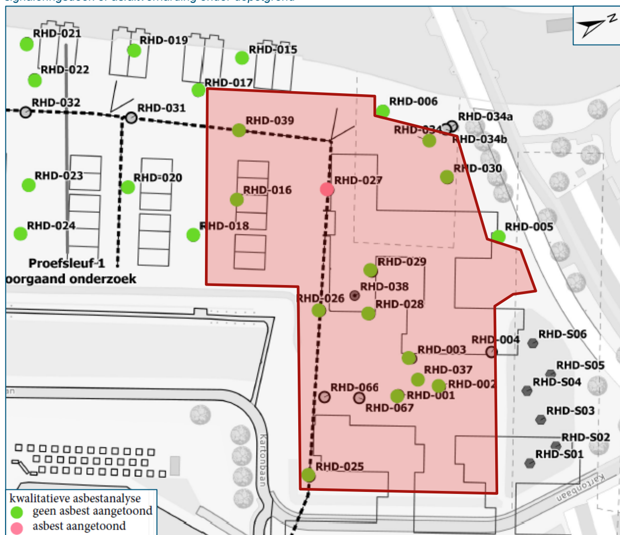
Figuur 4.7: resultaten analyses asbest woonvelden 1, 10 en 11 (kwalitatief); rood gebied betreft gebied met signaleringsdoek of asfaltverharding onder depotgrond
