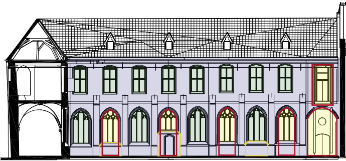
Westgevel pandhof met haar historische gelaagdheid
