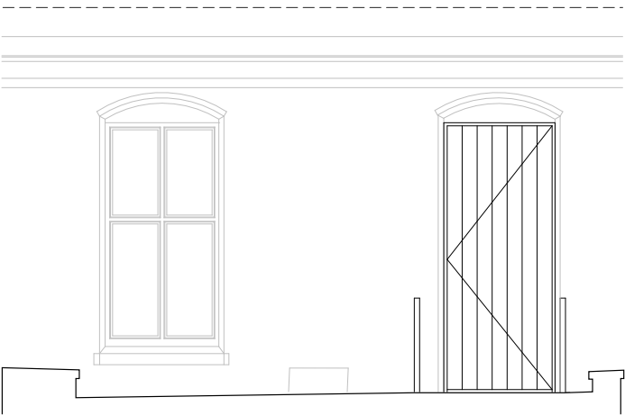
Principetekening vluchtdeur noordelijke kloostergang, westzijde (zie gevelaanzicht pandhof, document 3221)
