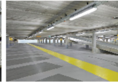
De parkeerplaatsen ingevuld met een donkere kleur voor een duidelijk onderscheid met de rijbaan. De voetgangerszone als gele strook ter begeleiding van de stroom en ter verhoging van de veiligheid.
