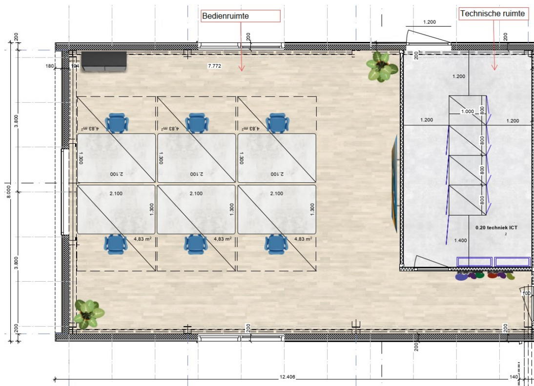
Afbeelding 4.3 Indeling bedienruimte en technische ruimte (zie par. 4.4)
