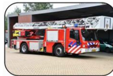
RV Redvoertuig vrije ruimte opstelplaats 12,0 x 5,0 m (lxb) incl. 1,0 m rondloop
