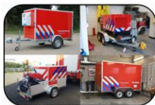
OA Operationele Aanhang vrije ruimte opstelplaats 12,0 x 5,0 m (lxb) incl. 1,0 m rondloop
