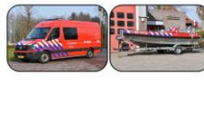
OVRT Oppervlaktereddingsteam vrije ruimte opstelplaats 12,0 x 5,0 m (lxb) incl. 1,0 m rondloop
