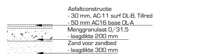
Principedetail asfalt vrijliggend fietspad Schaal: 1:50
