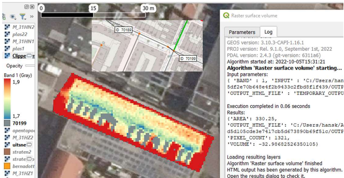
Afbeelding 4.2 voorbeeld bepalen berging op straat bij put 70199
