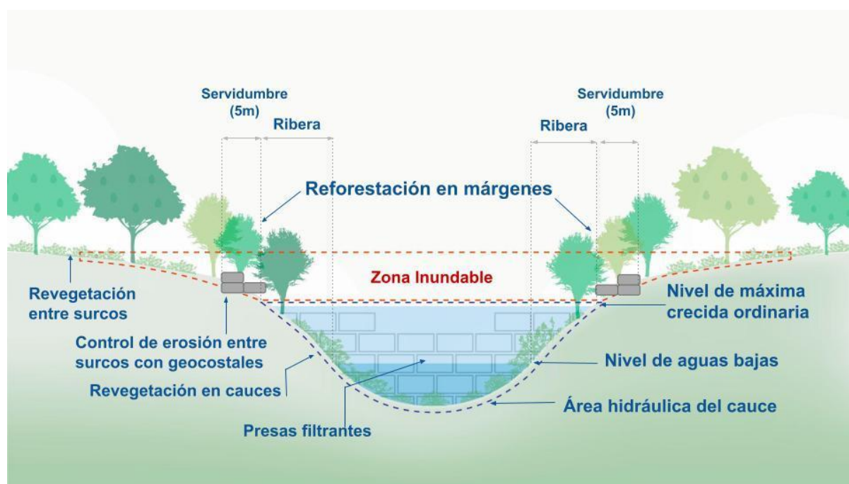
Imagen 42. Perfil esquemático de un cauce con intervenciones.
