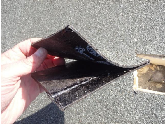
7: matige verkleaving toplaag op onderlaag
