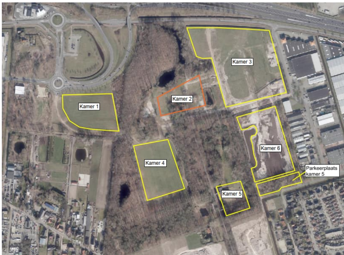
Afbeelding 42. Indicatie te plaatsen rasters om de ontwikkelkamers (geel omlijnd). Kamer 2 kan pas volledig afgerasterd worden zodra de aanwezige hopen verwijderd zijn.
