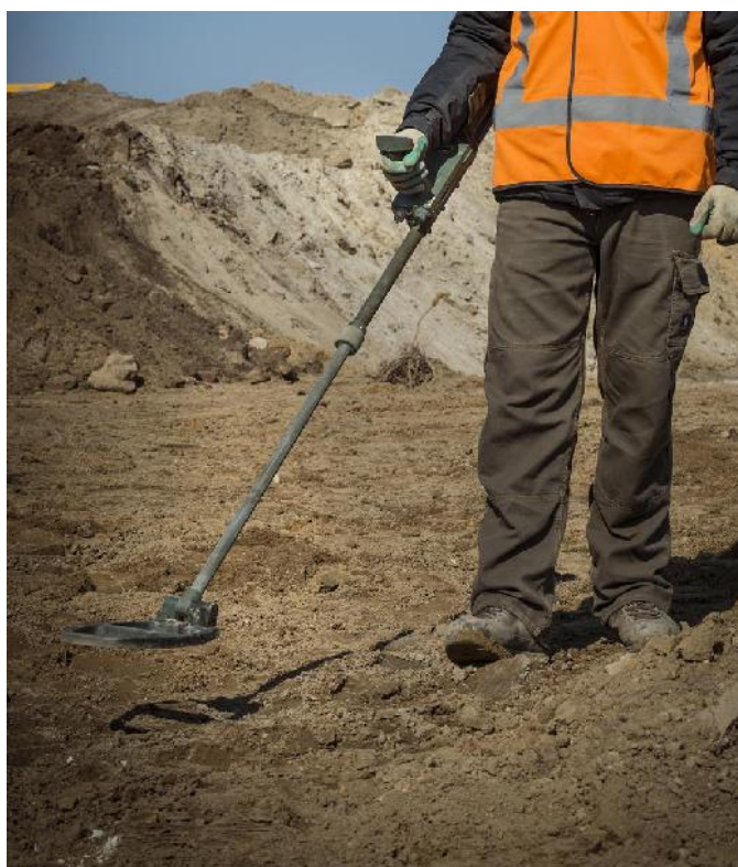
Impressie realtime oppervlakedetectie met de mijndetector.
