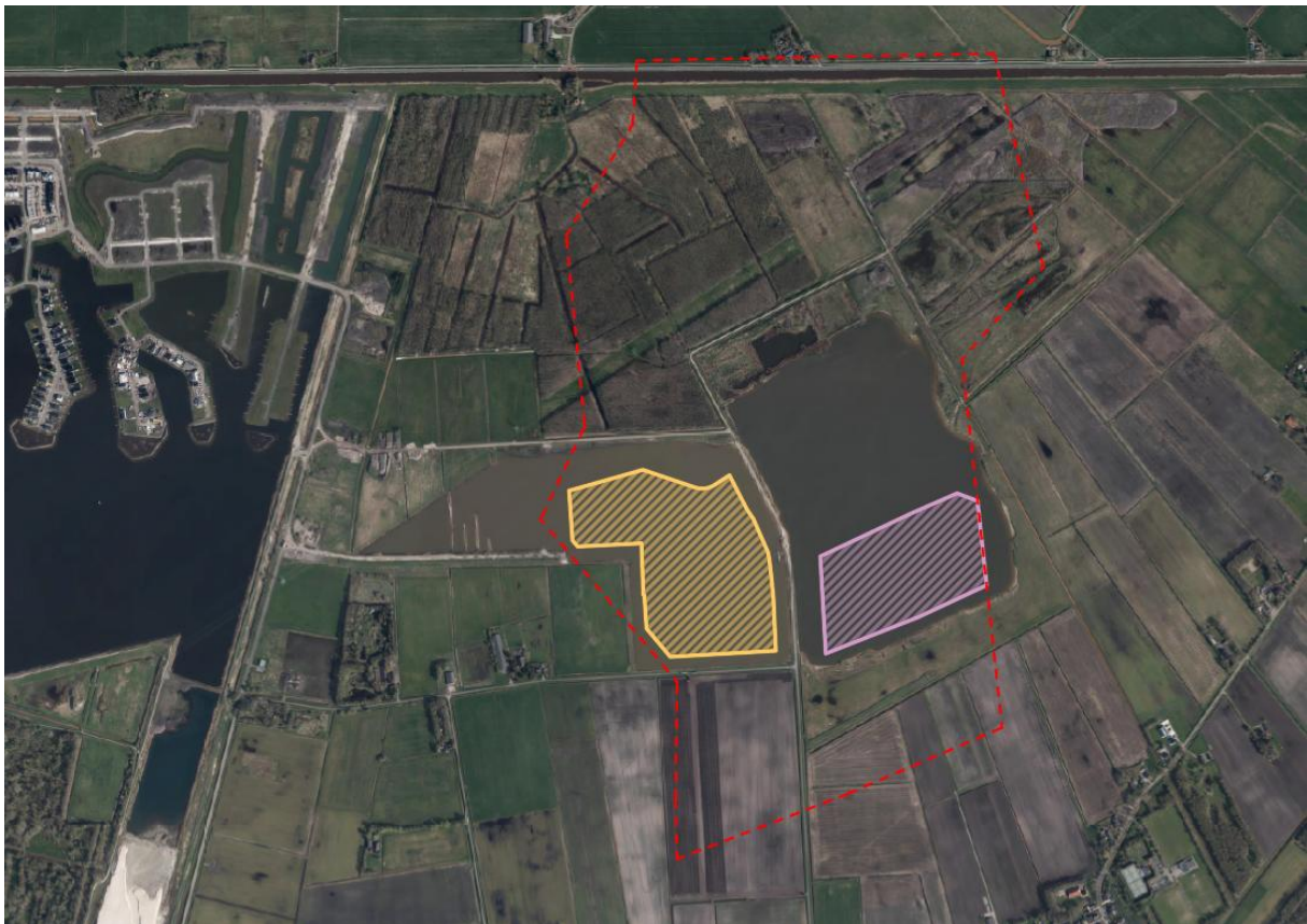
Afbeelding 2: De zone waarbinnen het Woldmeer tot NAP -9,00 meter mag worden afgegraven en de locaties waar dit is gebeurd (roze) en waar dit gaat gebeuren als onderdeel van dit werkplan (geel).
