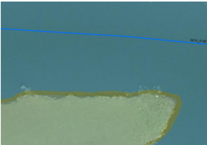
Afbeelding 13. Een kenmerkende situatie in veengebied met brede sloten, hoge waterstand en minimaal talud. Bij het muteren van dit waterdeel wordt geen nieuw ondersteunend waterdeel ingetekend. Het waterdeel komt te liggen op de waterkant. Het begroeid terreindeel wordt niet gemuteerd.
