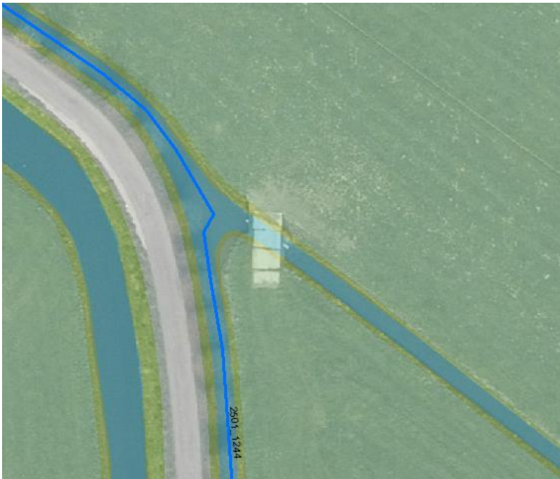
Afbeelding 12. Watergang is plaatselijk gedempt, een dam met duiker is aangelegd. Het waterdeel, ondersteunend waterdeel, duiker, begroeid en onbegroeid terreindeel worden gemuteerd om de BGT te actualiseren.
