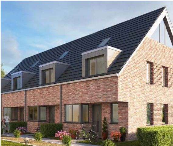
Afb. 3.21 - zadeldak langskap, dakkapelen en gevelverspringing
