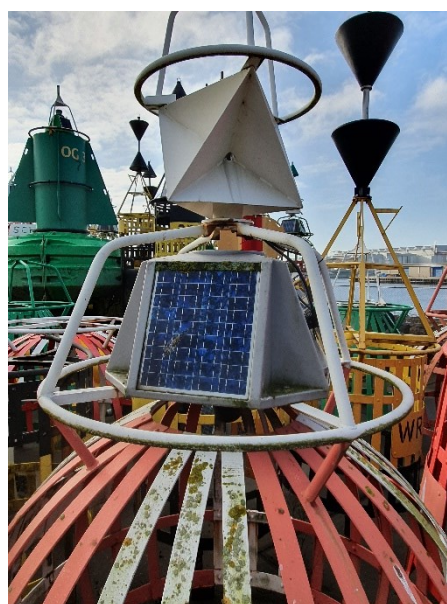
Afbeelding 7: "Oud" zonnepanelenrek in spinnenkop.
