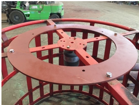
Afbeelding 11: Verloopring, gemonteerd op dagmerk.
