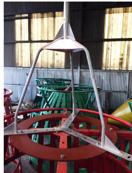
Afbeelding 12: Verloopring en kaap.
