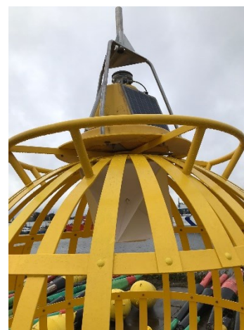
Afbeelding 2: Bovendeel van dagmerk van lichtboei met daarboven verloopring, kaap en integrale lichtunit.
