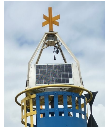
Afbeelding 3: Bovendeel van dagmerk van raconboei met daarboven raconkaap.
