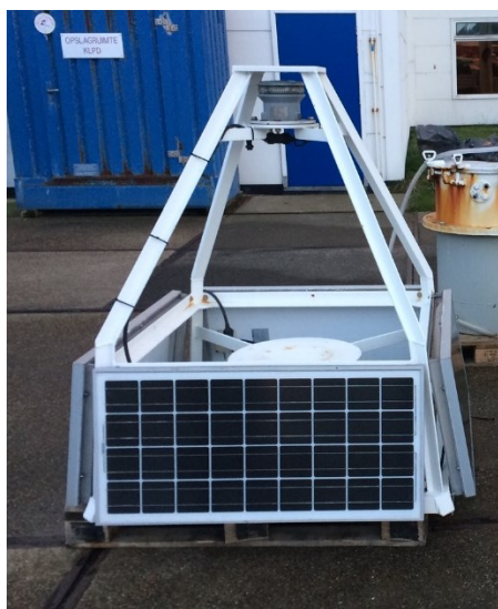
Afbeelding 16: Raconkaap voor stalen boei.
