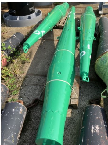
Foto 4: Stalen sparren (ijsbetonning).
