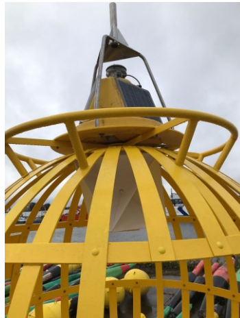
Foto 2: Bovendeel van dagmerk van lichtboei met daarboven verloopping, kaap en integrale lichtunit.
