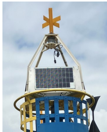
Foto 3: bovendeel van dagmerk van raconboei met daarboven raconkaap.
