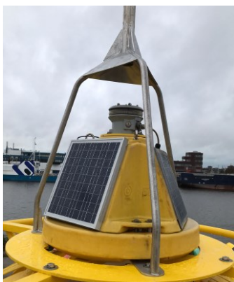
Foto 9: Stalen verloopring met RVS kaap en daarin integrale lichtunit.
