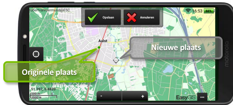
Figuur 49: Verplaatsen van een paal
