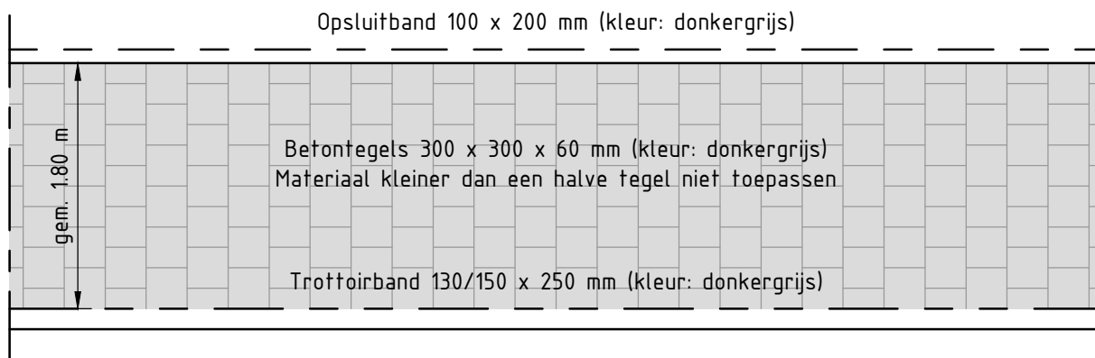
Principe detail gemiddeld voetpad
