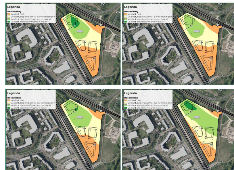
Figuur 10 Invloed van gebouwhoogte op de beoordeling van de trillingen in de nachtperiode. Linksboven voor 3 lagen, rechtsboven 4 lagen, linksonder 5 lagen en rechtsonder 6 lagen
