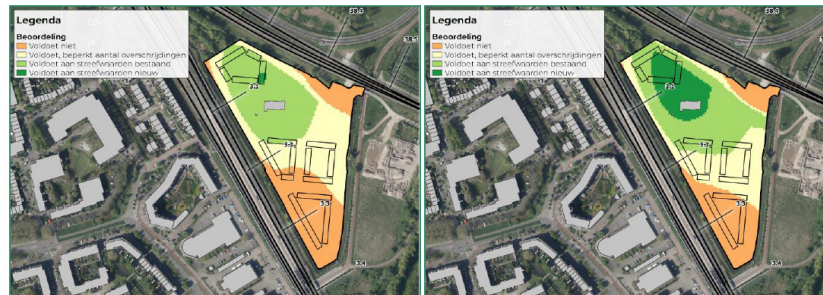
Figuur 14 Beoordeling van 5-laags concept zonder sloot (links) en met verdiepte spoorsloot (rechts) voor nachtperiode
