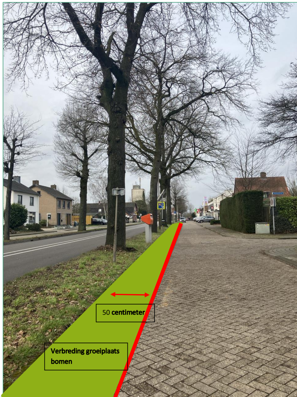
Afbeelding 4.7 Alternatief opsluitbanden met groeiplaatsvergroting bomen.
