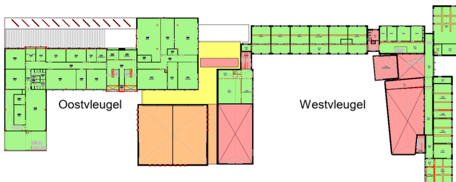
Zones mogelijkheden zonnepanelen en/of luchtbehandelingskast
