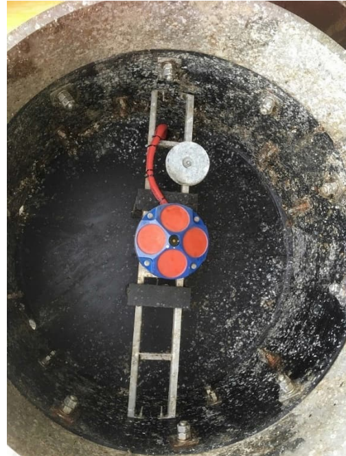
Figuur 6: Onderzijde meetboei met ADCP
