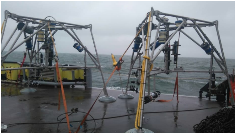
Figuur 1: Grote meetframes met meerdere sensoren
