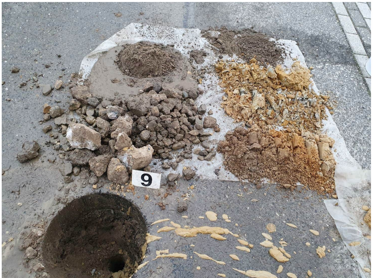
Afbeelding 3: Foto boorprofiel, boring W09 in weg; leesrichting van linksboven naar rechtsonder
