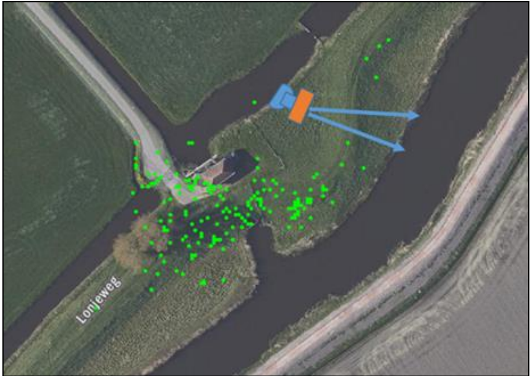
Afbeelding 5. De situering (richting) van het gemaal wordt afgestemd op de aanwezigheid van planten van de Tengere distel in het werkgebied. Dit is op een locatie waar momenteel geen planten staan. Aanvoer van materiaal en materieel vindt, om planten te sparen, plaats via het weiland en niet via de ingang bij het oude gemaal.
