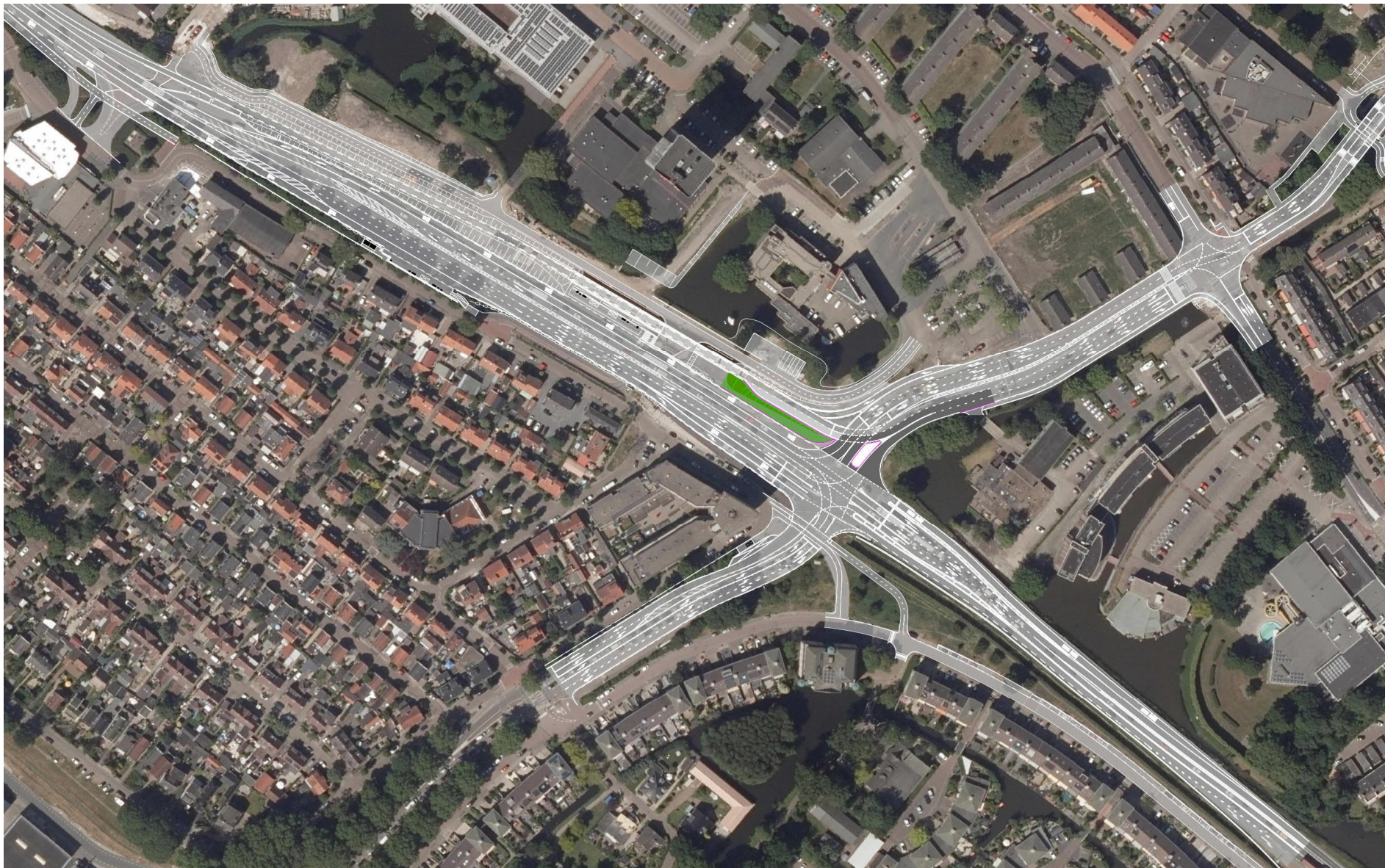
Afbeelding 4.5 Variant 1, extra opstelcapaciteit voor linksafslaand verkeer op wisselstrook
