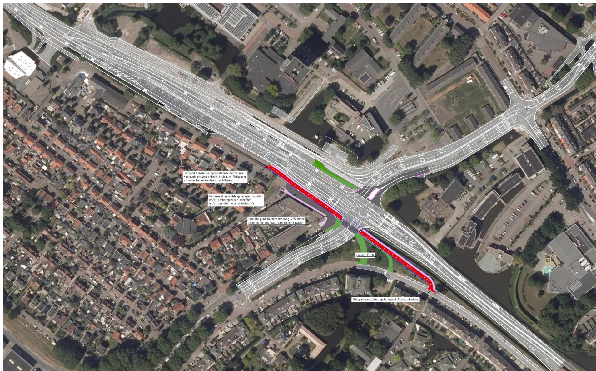
Afbeelding 4.6 Variant 2, extra opstelcapaciteit met aanvullend een fietstunnel
