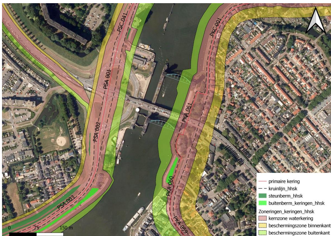
Afbeelding 5.4 Locatie primaire waterkeringen bij de Algerabrug (HHSK, sd)
