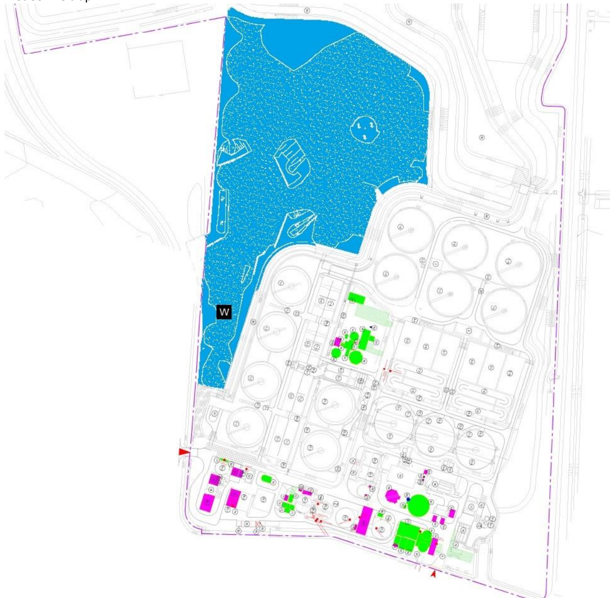
Figuur 1 Beschikbaar terrein RWZI Tilburg voor toekomstige activiteiten (blauw gearceerd); de paars onderbroken lijn is de terreingrens; W =bestaande windmolen. Voor de uitbreiding met de vierde zuiveringstrap is circa 50% van het blauw gearceerde terrein beschikbaar.
