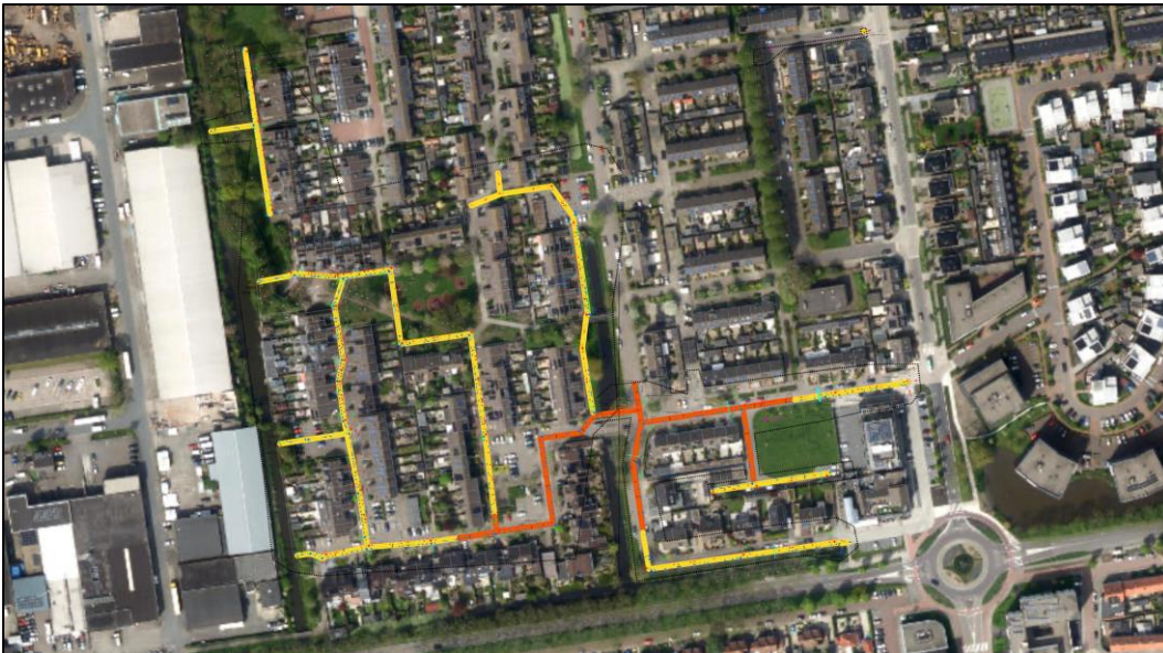
Figuur 4 – Onderdelen met b.o.b. geel -5,23 tot -5,90 mNAP en oranje -5,90 tot -6,49 mNAP
