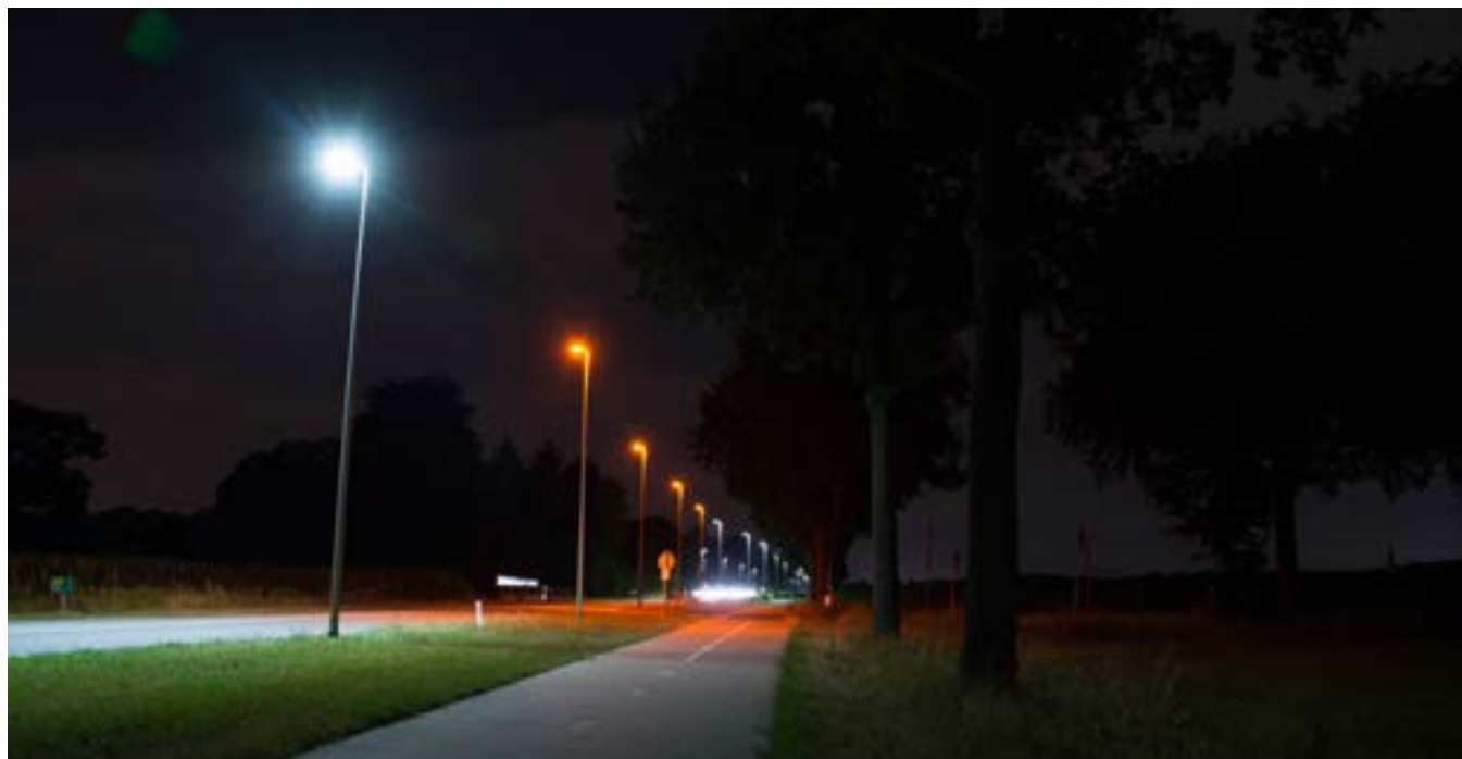
Vleermuisvriendelijke verlichting waar een vliegroute een weg kruist (Bron: Jasja Dekker Dierecologie)
