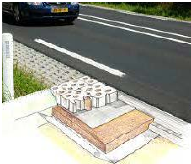
Doorsnede van een zwijnverdwijnblok
