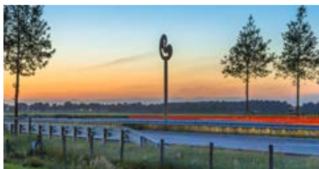
Voor een functionele hop-over over een meerbaansweg wordt aangeraden in de middenberm een extra verhoging aan te brengen in de vorm van een boom of een andere structuur (Bron: Rudmer Zwerver)
