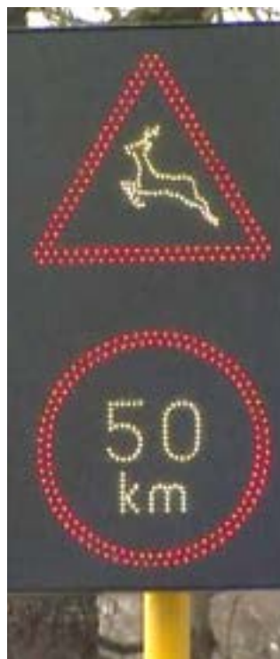
Een sensor die wild detecteert en een elektronisch waarschuwingsbord aanstuurt
