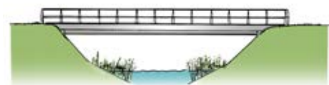
Profiel van een brug/viaduct met een doorlopende oever als faunavoorziening
