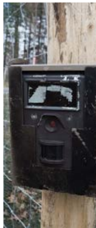
Een sensor die wild detecteert en een elektronisch waarschuwingsbord aanstuurt
