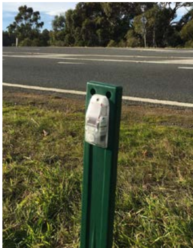
Sensor op paaltje die wordt geactiveerd door koplampen en een licht- of geluidssignaal produceert (Bron: Wildlife Safety Solutions)
