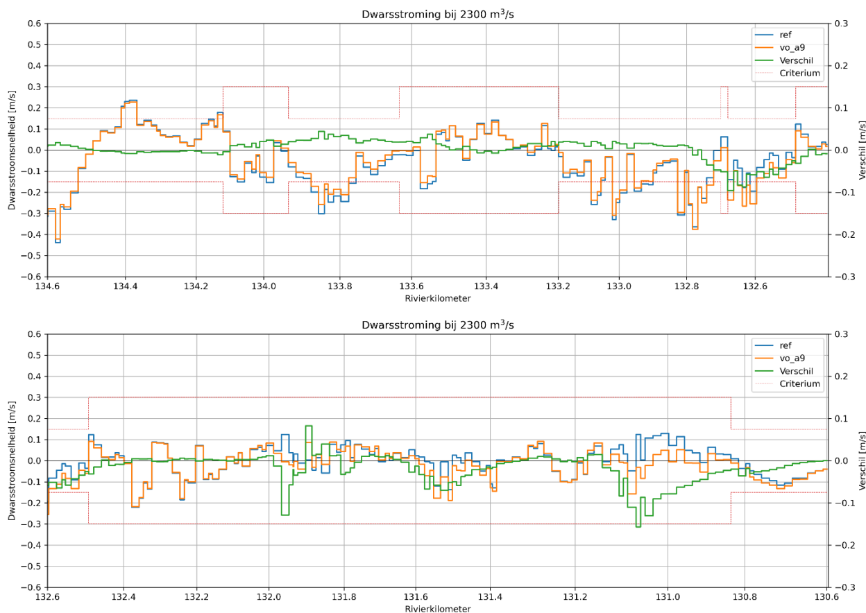
Figuur 7.5 Dwarsstroming op de rand van de vaarweg (m/s) bij 2300 m 3 /s tussen het ontwerp (in figuur 'vo_a9') en de referentie (in figuur 'ref').
