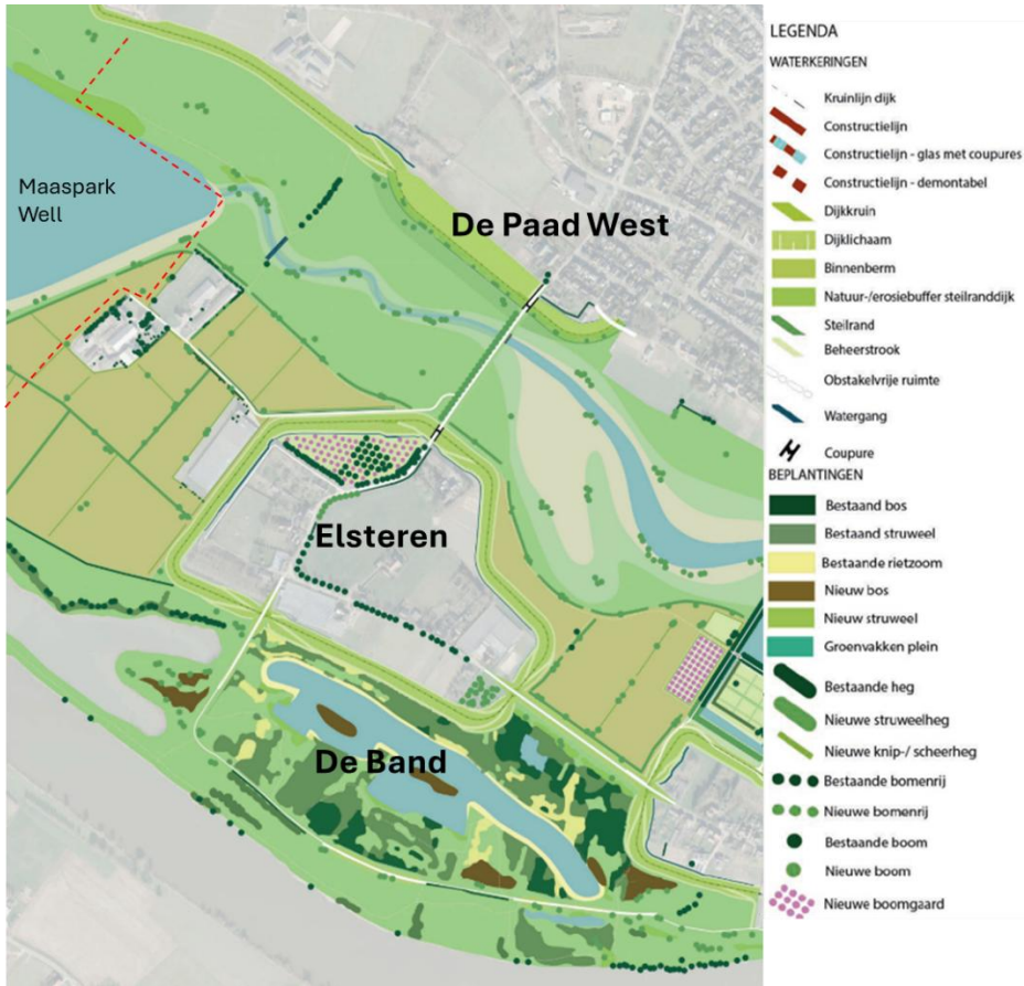
Figuur 2-2 Overzicht van dijkwerkzaamheden en gebiedsontwikkeling Groene Rivier Well in het middendeel van het plangebied met naamgeving deelgebieden
